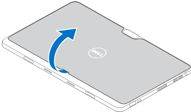
3. Deslize a trava de liberação para desbloquear a bateria. Levante e remova a bateria do tablet.
